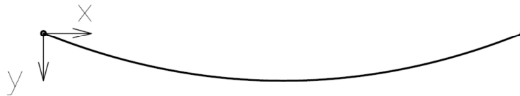
Souřadnicový systém pro výpočet geometrie nosného lana
